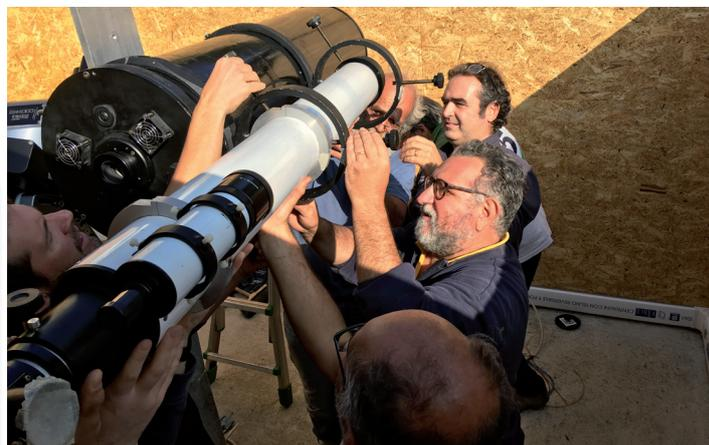
La strumentazione è costituita dalla professionale montatura alla tedesca GM 4000, con il riflettore Cassgrain da 30 cm di diametro al centro, sul lato sinistro il rifrattore da 12 cm con al di sopra un Lunt da 60, per l'osservazione della corona solare e a destra un C 14 Celestron.
